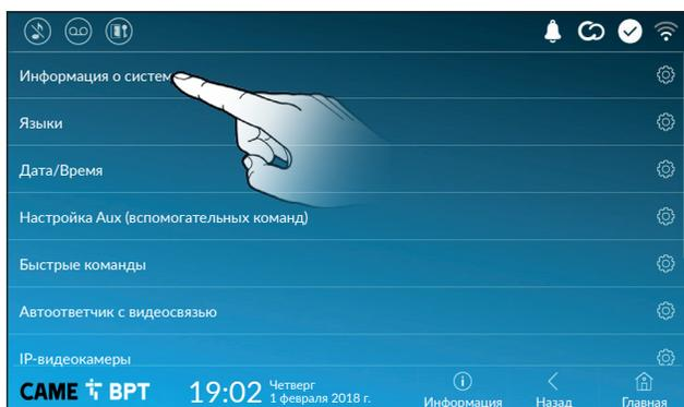
В этом окне содержится ряд полезной технической информации для определения характеристик устройства, версии программного и аппаратного обеспечения.
