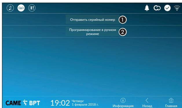
1 Кнопка позволяет отправлять серийный номер (SN) программному обеспечению Pcs/Xip на этапе программирования.
