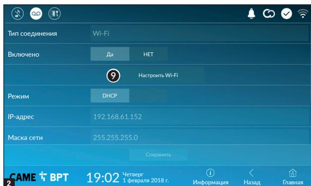
9 После выбора режима соединения эта кнопка позволяет выбрать и настроить сеть Wi-Fi.
