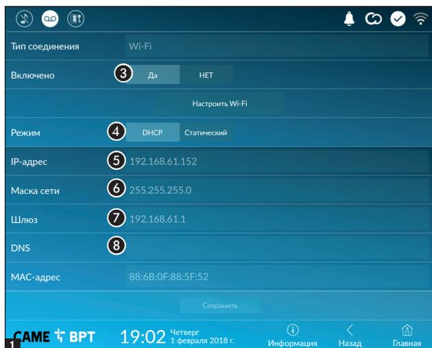
3 Кнопка предназначена для включения/выключения соединения Wi-Fi.
