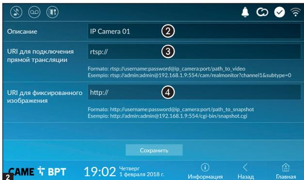
2 Коснитесь этой области, чтобы присвоить имя добавляемой IP-видеокамере.
