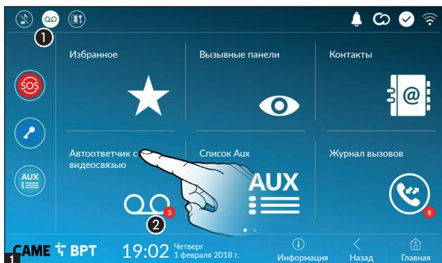
1 Коснитесь иконки для включения/выключения автоответчика.
