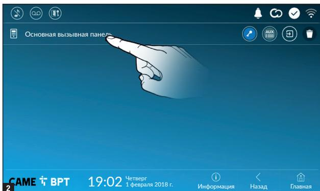
Открывает дверь, присвоенную соответствующей вызывной панели, без установки соединения.
