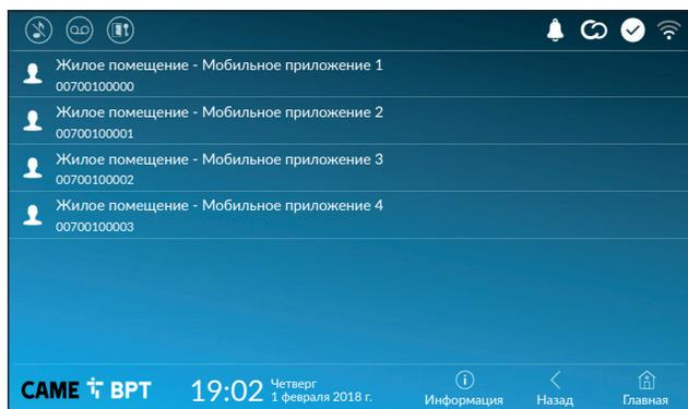
Это окно позволяет отображать параметры доступа для 4 систем, которые могут подключаться к устройству через смартфоны и планшеты.
